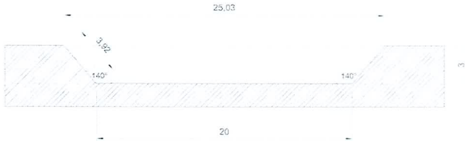
Figura N°3: Perfil zanja localidad de Baquedano
